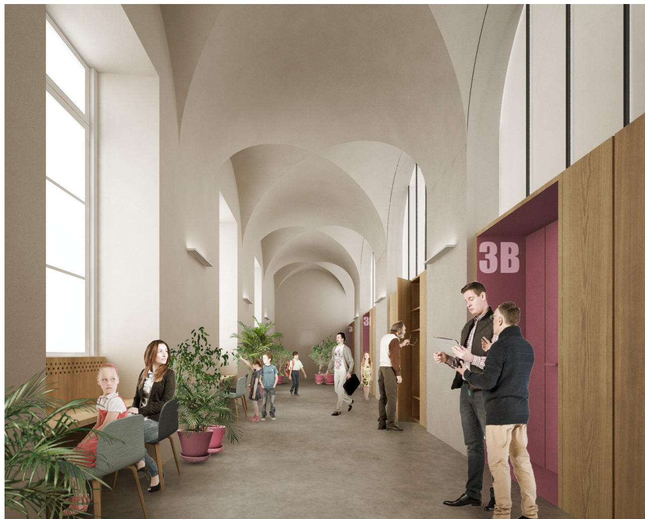
Le nuove pareti attrezzate definiscono il margine tra aule e corridoio, costruendo un supporto per le attività e permettendo una maggiore illuminazione naturale
