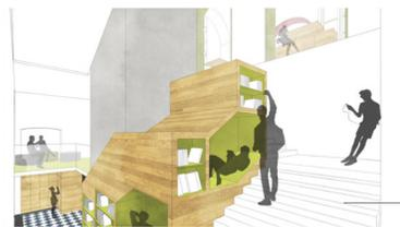
Un'armadiatura profonda costruita attorno alla torre dell'ascensore esistente permette di chiudere in nicchie i libri e di inserire postazioni grotta per la lettura individuale.
